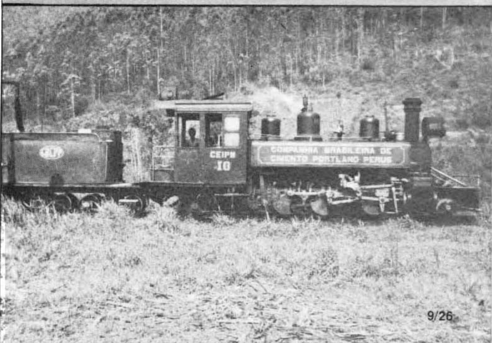
AO LADO - Locomotiva nº 10, originalmente nº 911, na Paulista, fotografada em Cajamar, 1977. Note a grande distância que resultou no acréscimo do tender. Felizmente para o foguista o combustível passou a ser o óleo BPF. (Foto: Nilson Rodrigues)
