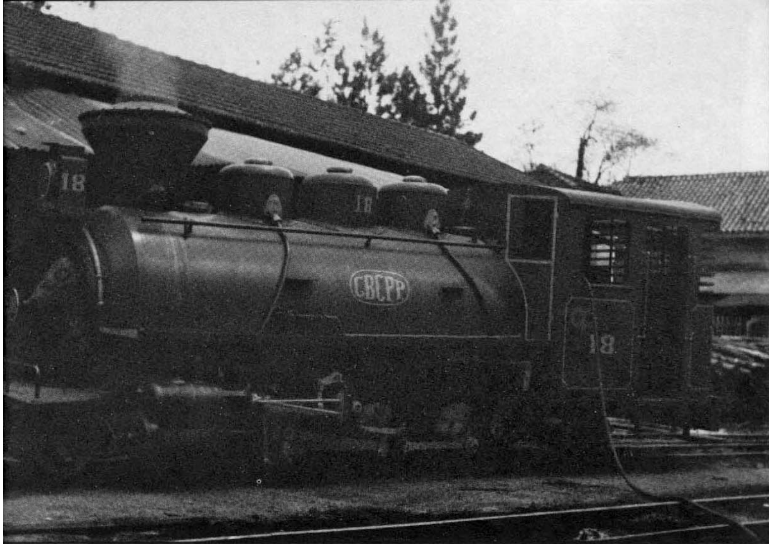
Locomotiva nº 18 (2-6-2 ST) - Fabricada na Usina Monte Alegre, em Piracicaba, tendo como base um chassis de locomotiva alemã. (Fotografada em Gato Preto, 1979: Nilson Rodrigues)
