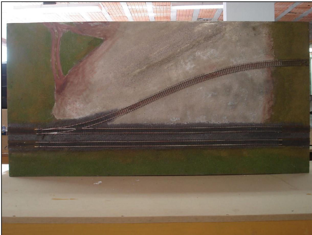
9. Um dos módulos desmontado. Observe que os elementos de decoração são adicionados somente após a montagem da maquete, podendo ser colocados em posições variadas,
